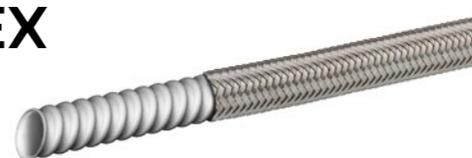
Сердечник из гофрированного снаружи, слегка волнистого изнутри ПТФЭ, наружная оплетка из нержавеющей стали для специальных условий эксплуатации.
